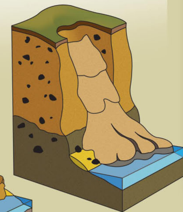
Rutschung an einem Kliff aus eiszeitlichen Ablagerungen
