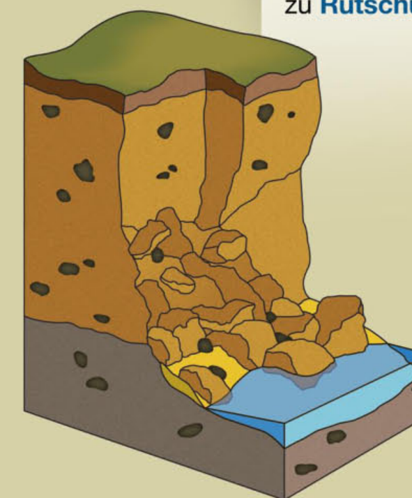
Abbruch an einem Kliff aus Geschiebemergel/Geschiebelehm
