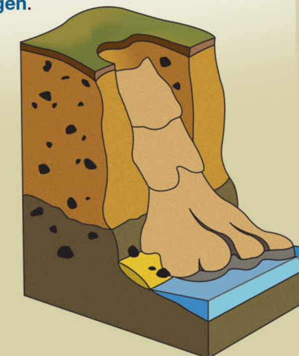
Rutschung an einem Kliff aus Geschiebemergel/Geschiebelehm
