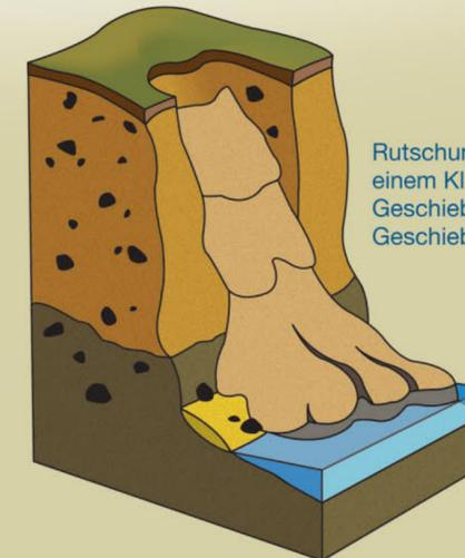
Rutschung an einem Kliff aus Geschiebemergel/ Geschiebelehm
