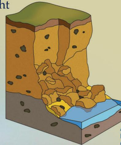
Abbruch an einem Kliff aus Geschiebemergel/
