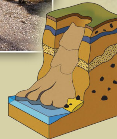
Abbruch (rechts) und Rutschung an einem Kliff aus Geschiebelehm
