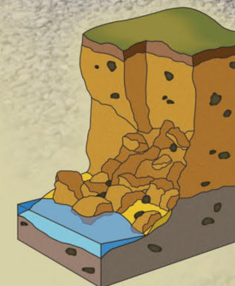
Abbruch (rechts) und Rutschung an einem Kliff aus Geschiebelehm
