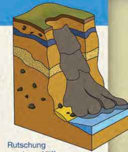
Rutschung an einem Kliff aus eiszeitlichen Ablagerungen
