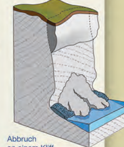
Rutschung an einem Kliff aus eiszeitlichen Ablagerungen
