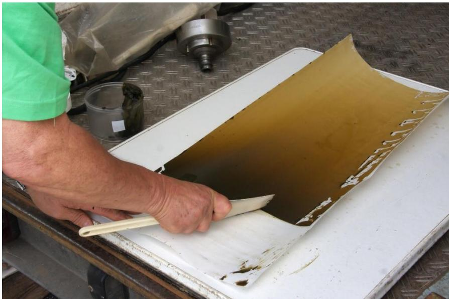
**Abb. 2.3-1:** Schwebstoffprobenahme mittels Durchflusszentrifuge CEPA Z 61
