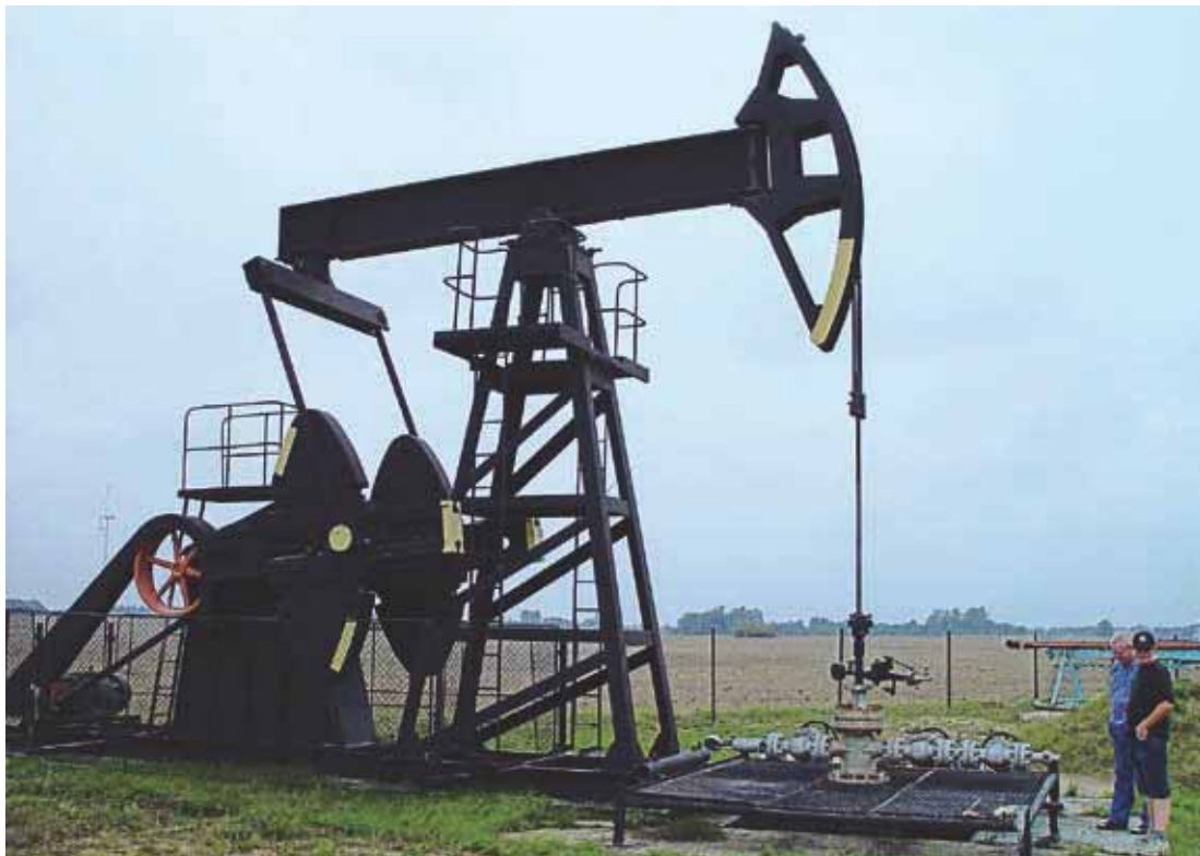
Zu den bedeutendsten Exponaten des Museums zählt dieses Technische Denkmal – ein Tiefpumpenantrieb mit Eruptionskreuz am Standort der ersten, 1961 in Mecklenburg-Vorpommern fündig gewordenen Erdölbohrung E Reinkenhagen 2/2a/60.
