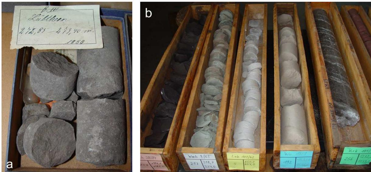
Abb. 31: (a) Einer der ältesten Bohrkernkerne in der Geologischen Landessammlung stammt aus der Bohrung Lübtheen III, die 1880 zur Erkundung des Salzstocks Lübtheen abgeteuft wurde. (b) Bohrkernkerne liefern wichtige Informationen über den Bau und die Nutzungsmöglichkeiten des tieferen Untergrundes. (Fotos: K. Obst, 2006)
