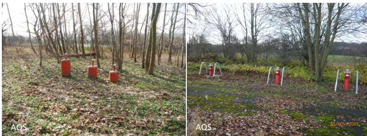
Abb. 23: Gruppen von Grundwassermessstellen in unterschiedlichen Tiefenlagen (links: alte GWM, rechts: neue GWM)
