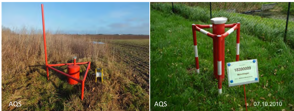
Abb. 22: Vergleich einer alten (links) mit einer neuen Grundwassermessstelle
