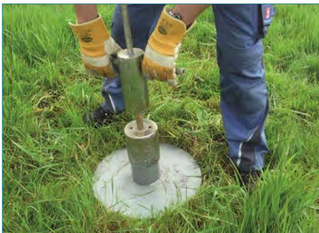
Abb. 2: Qualifizierte Probenentnahme zur Immissionsmessung an Böden mit einem Bohrstock.
