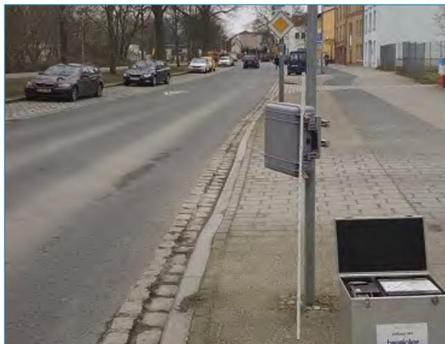
Abb. 1: Verkehrszählgerät des LUNG in Stralsund
