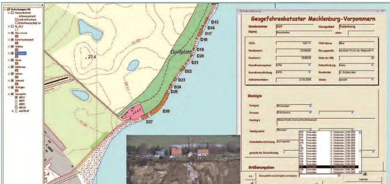
Abb. 1: Geogefahrenkataster – Beispiel Rutschung im Kliffbereich Dwasieden (s. Sassnitz) mit Darstellung Verknüpfung GIS-Komponente mit Fachdatenbank und Fotodokumentation, Quelle LUNG
