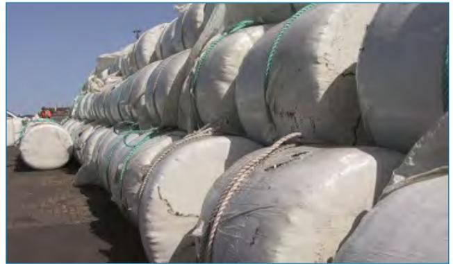
Abb. 5: Altholz, Ersatzbrennstoff in Ballen
