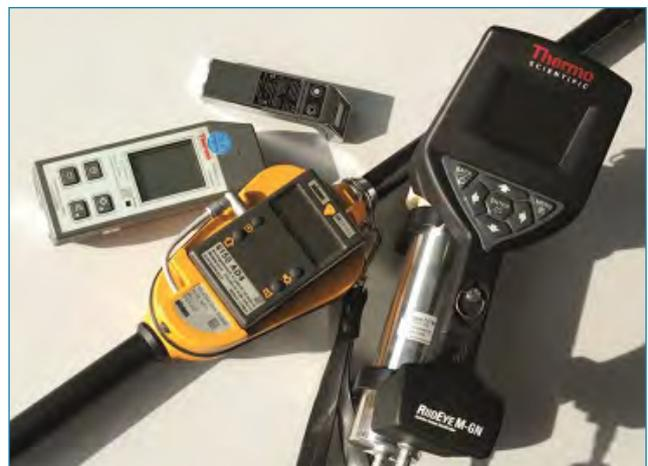
Abb. 3: Auswahl von Strahlenschutzmessgeräten zur Gefahrenabschätzung und Dosis-Abschätzung.
