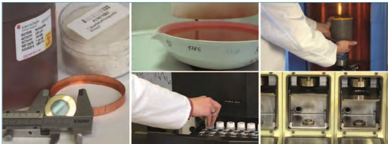
Abb. 5: Einblicke in die Radioaktivitätsmessstelle (Messpräparate, Oberflächenverdampfer, Low-Level-Gammamessplatz, Liquid-Scintillation-Counter, Alphamesskammern)
