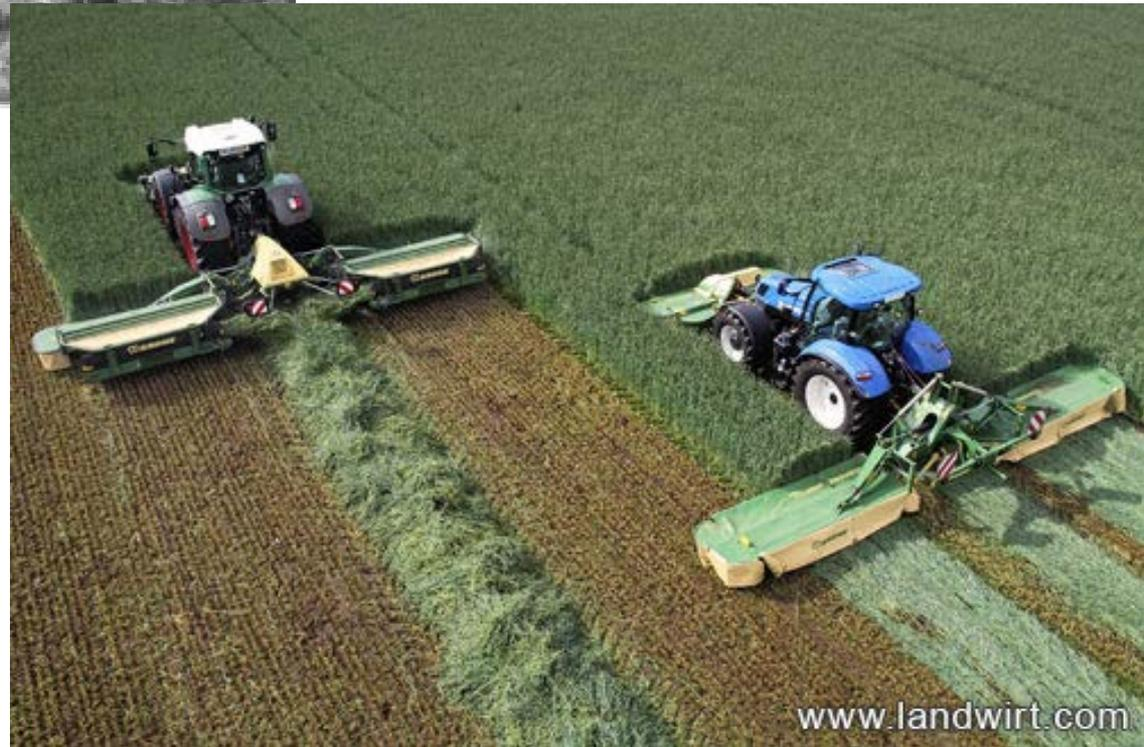
«.... an deren Umfang radial angeordnete bewegliche Schneidmesser angebracht sind, die bei einer Umfangsgeschwindigkeit von zirka 60 m/s die Pflanzen im freien Schnitt vom Wurzelstock trennen.» (Studer 2002)
