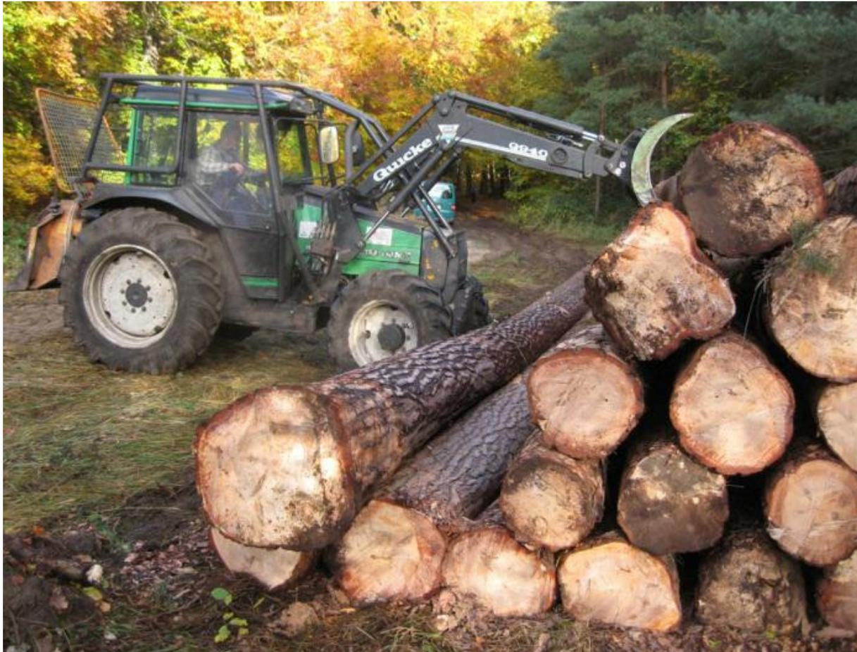
**Rücken und Poltern** von Langholz mittels Standardtraktor mit heckseitiger Rückwinde und frontseitigem Polterschild
