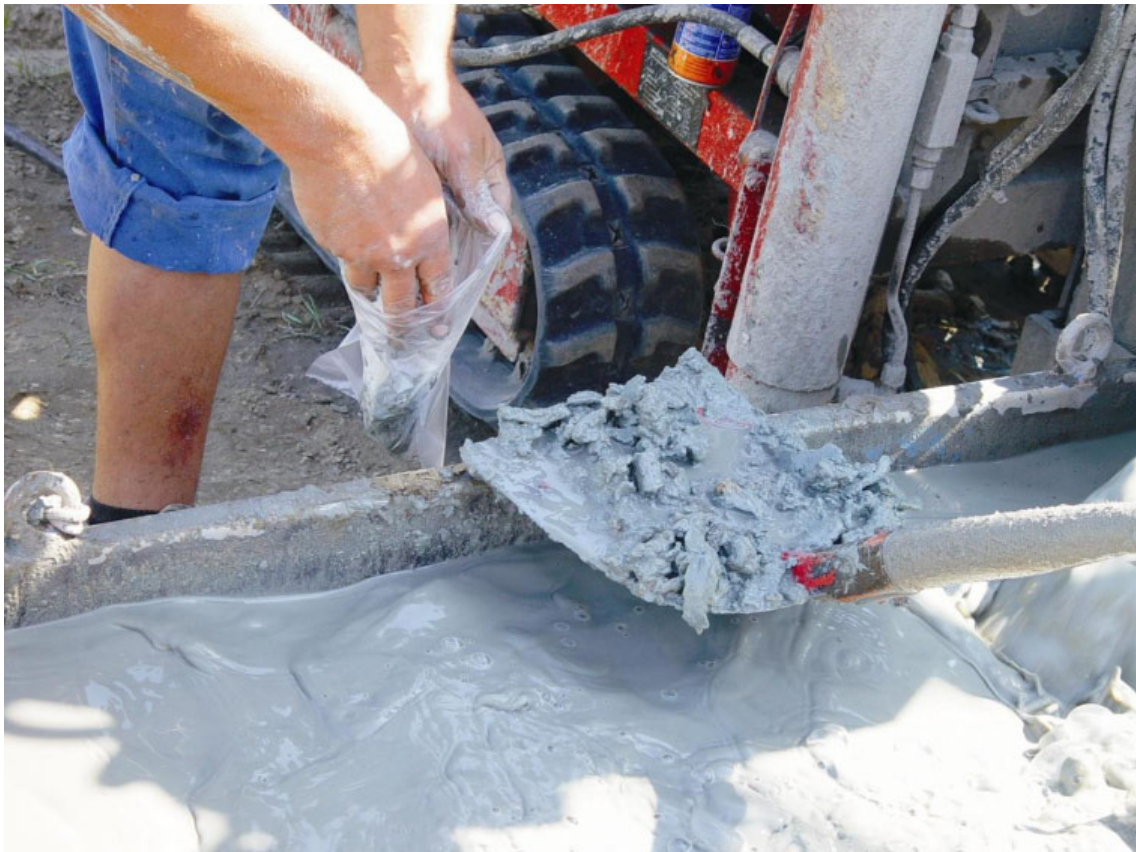
Abb. 15: Probennahme bei einer Spülbohrung
