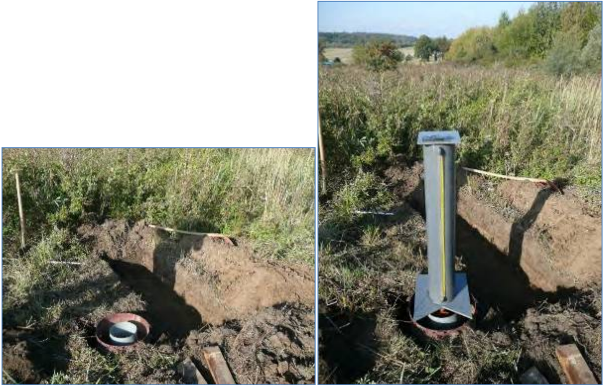
Abb. 34 und 35: Schürf 1, Doppelringinfiltrometer, Messung der Wasserdurchlässigkeit in der Oberbodenschicht in ca. 15 cm Tiefe
