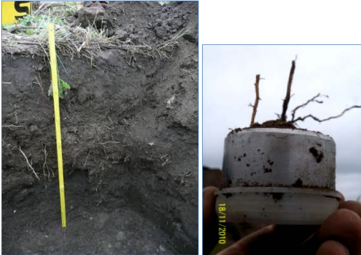
Abb. 69 und 70: Bis 1 m Tiefe sehr gute Durchwurzelung, die auch bei der Stechzylinderentnahme auffiel.
