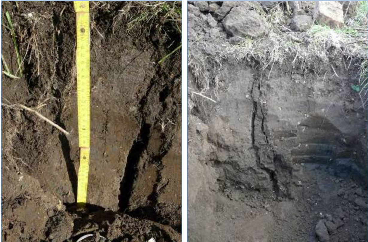
Abb. 84 und 85: Starke Rissbildungen bei beiden Schürfen, sowohl am Südwest- als auch Nordosthang infolge der starken Restschumpfung des zu nass eingebauten Materials. Risse mit mehreren Millimeter Breite, so dass ein Zollstock hineinreicht, gehen bis zu 80 cm in die Tiefe.
