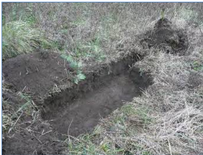
Abb. 64 und 65: Anlage Schurf 1, Oberboden sehr gut durchwurzelt und keine Rissbildung erkennbar.
