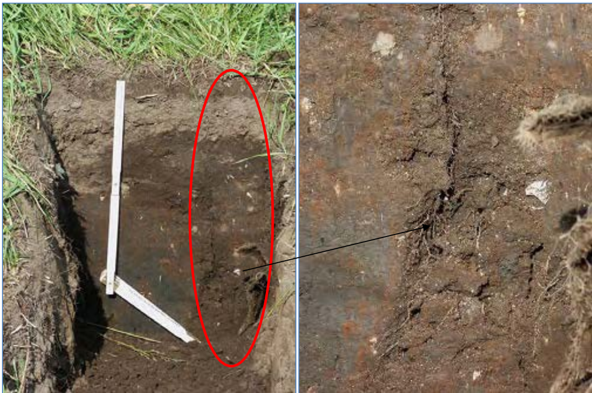
Abb. 92 und 93: weitgehend verfüllte Risse im Oberboden (0–50 cm), Durchwurzelung bevorzugt im Bereich des Risses
