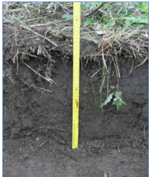
Abb. 64 und 65: Anlage Schurf 1, Oberboden sehr gut durchwurzelt und keine Rissbildung erkennbar.
