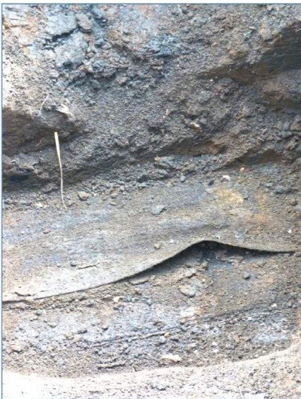
Abb. 97: Substratprobe aus ca. 80 cm Tiefe, intensive Oxidation des sehr eisenhaltigen Baggergutes
