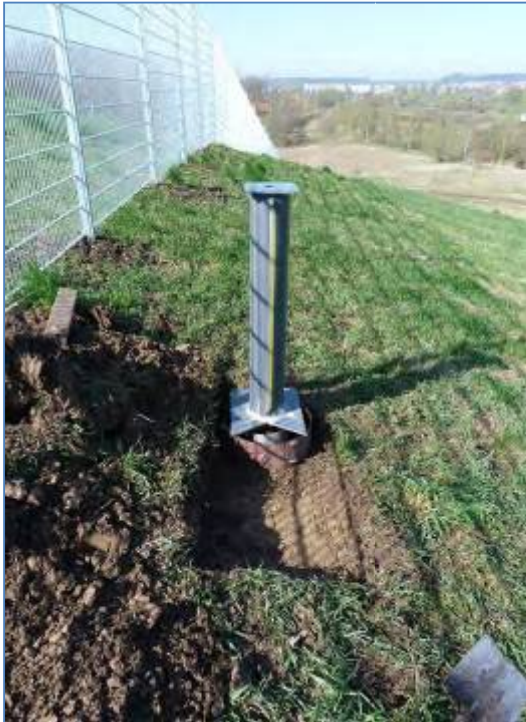
Abb. 16: Aufbau des Feldinfiltrimeters
