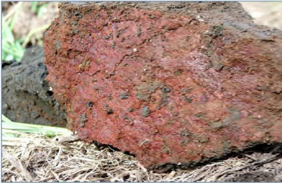
Abb. 97: Substratprobe aus ca. 80 cm Tiefe, intensive Oxidation des sehr eisenhaltigen Baggergutes
