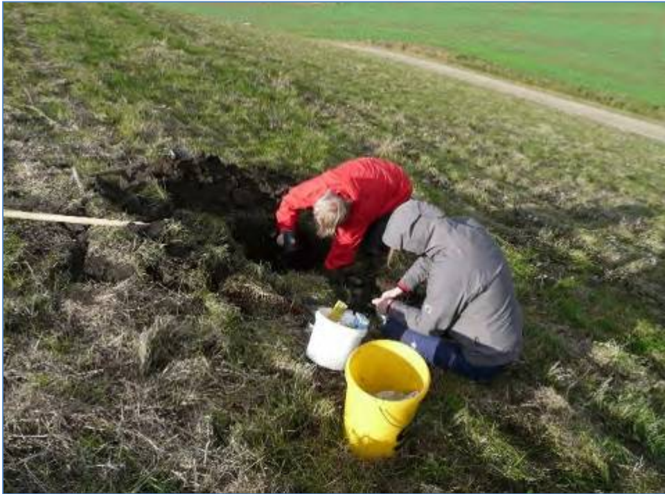
Abb. 83: Entnahme von Stechzylindern aus dem Oberboden 0 – 30 cm, Nordhang.
