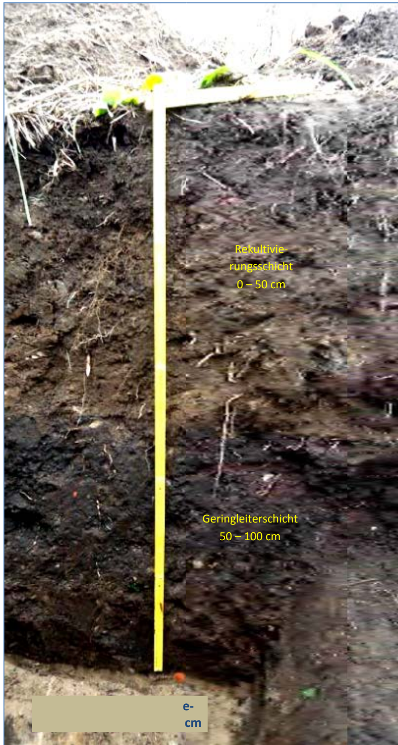
Abb. 45: Schürf 2, 0 – 1 m Tiefe, darunter Ausgleichsschicht aus Geschiebenmergel
