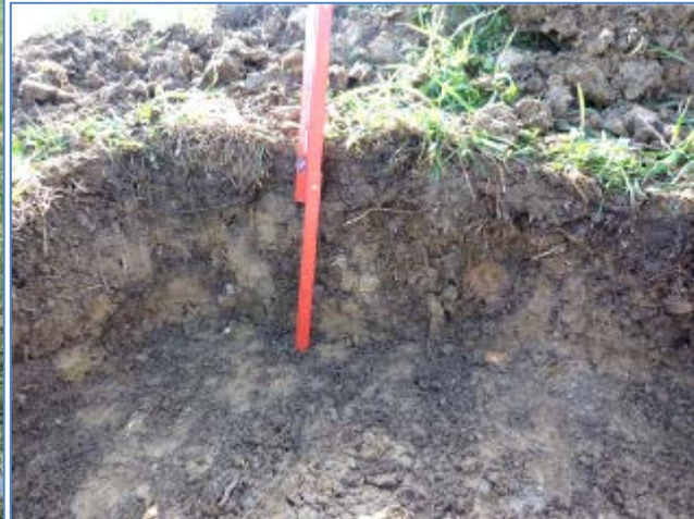
Abb. 17: Oberbodenbereich 0 – 25 cm aus Mergel, Ober-schicht (0 – 25 cm) geringe Durchmischung mit Baggergut
