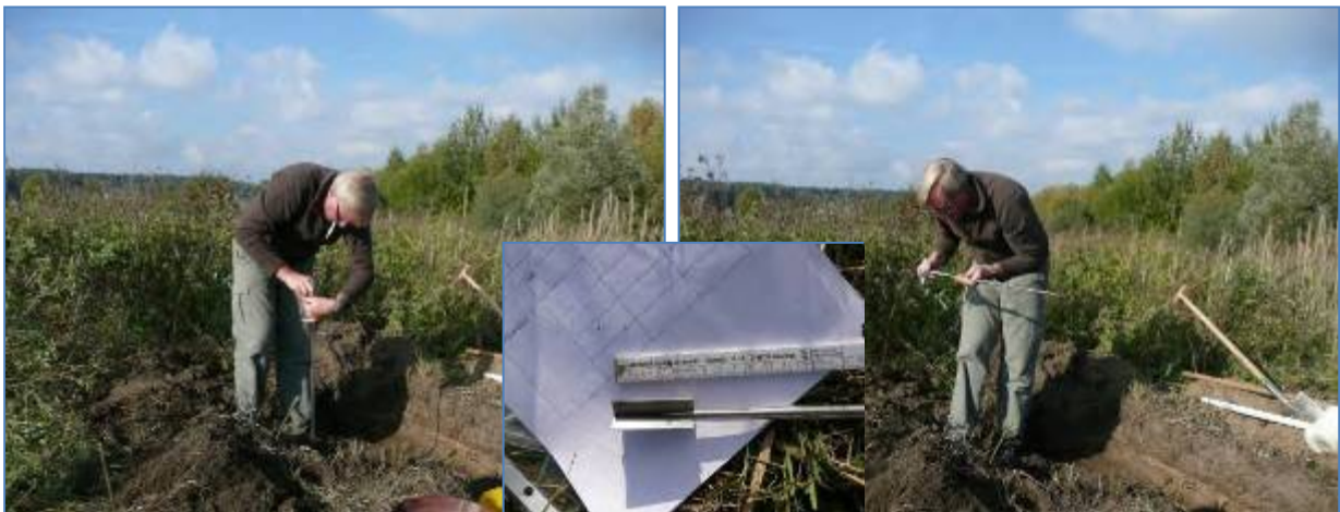
Abb. 36 – 38: Schürf 1, Scherversuch in der Oberbodenschicht bei ca. 15 – 20 cm
