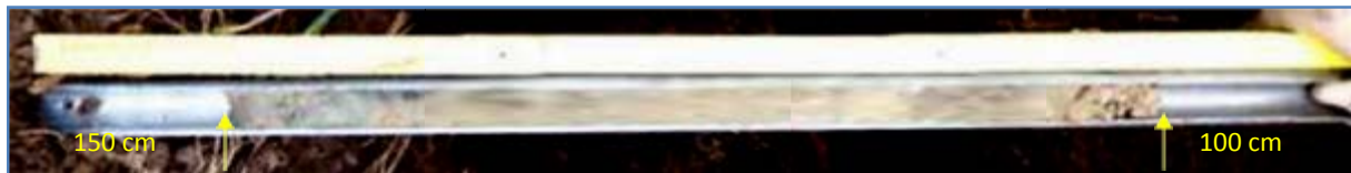
Abb. 49: Sondierung in die Ausgleichsschicht aus Geschiebemergel bis auf eine T efe von 150 cm
