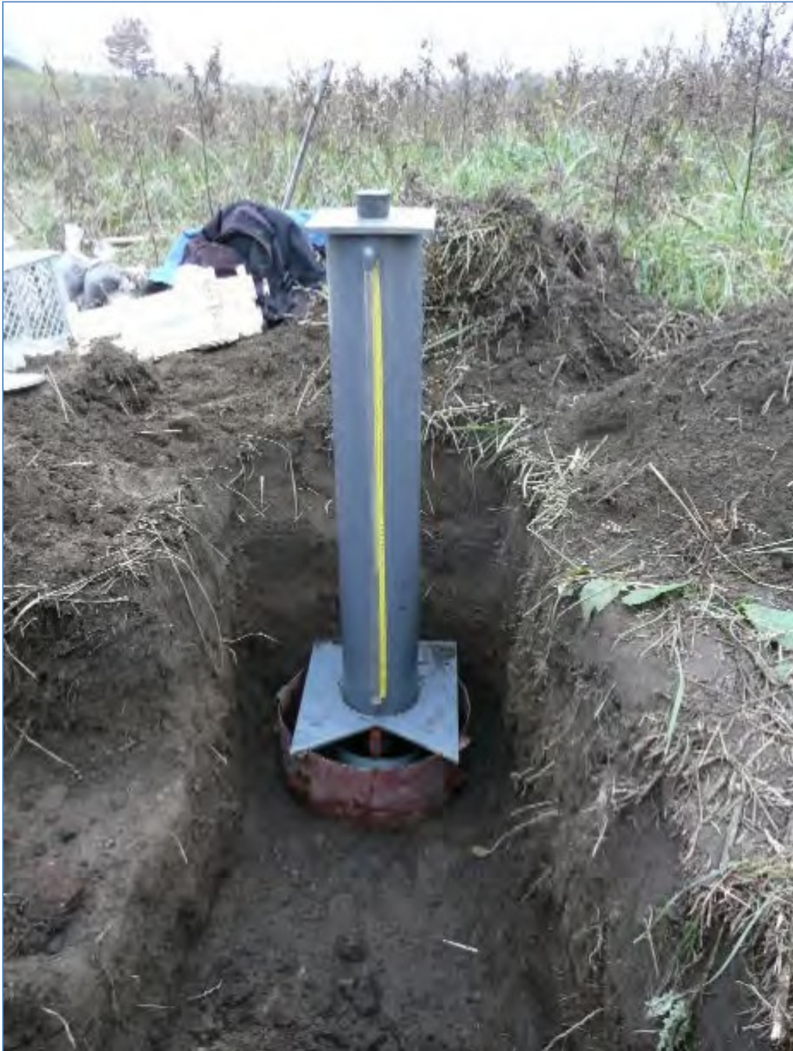
Abb. 68: Schürf 1 NIR, Doppelringinfiltrometer, Messung der Wasserdurchlässigkeit in 75 cm Tiefe
