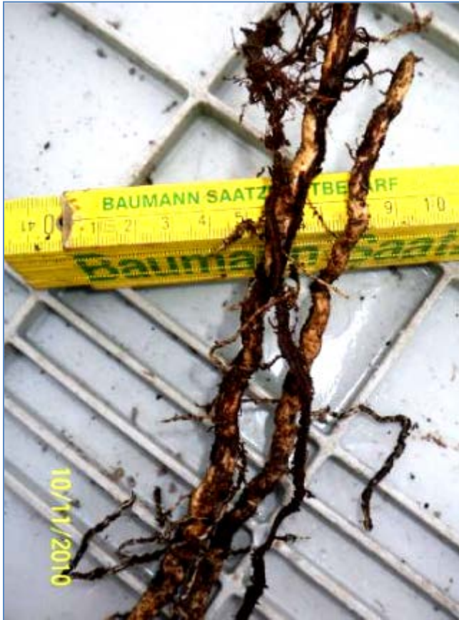
Abb. 46: Schurf 2; Wurzeln in 0,75 m Tiefe; vollkommene Durchwurzlung der Rekultivierungsschicht und bis in die Geringleiterschicht hinein
