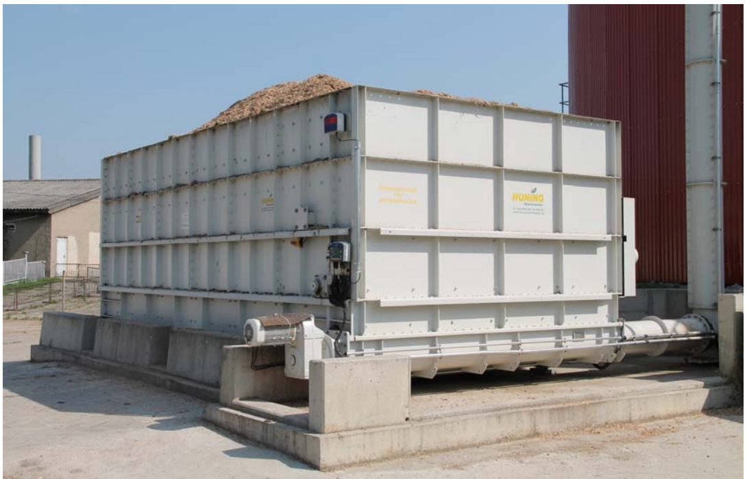
Foto 14: Blick auf einen Feststoffdosierer mit Schubbodensystem und einen Teil der sich anschließenden Fördereinrichtungen.
