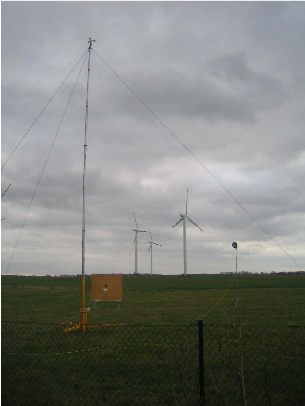
Abbildung 38: Stativanordnung mit Mikrofon, Anemometer im Vordergrund, Messung am 26.11.2009
