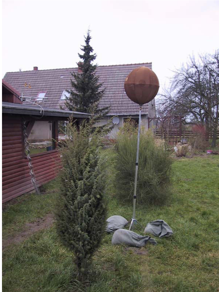
Abbildung 35: Mikrofon am MP 4 in ca. 2,0 m Höhe, Messung am 07.01.2005
