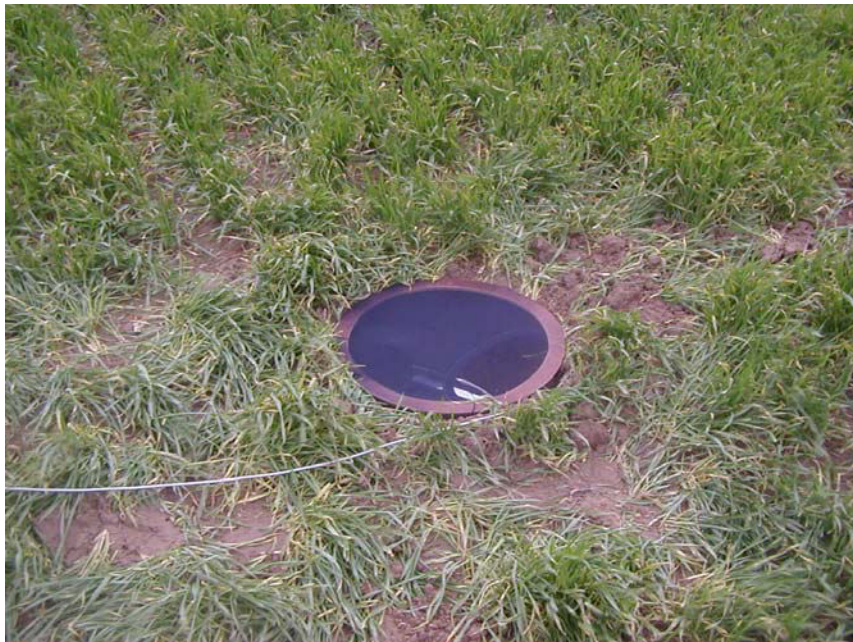
Abbildung 1: Mikrofon MP 3 erdbündig auf einer Ringplatte (strömungsoptimiert), Messung am 07.01.2005
