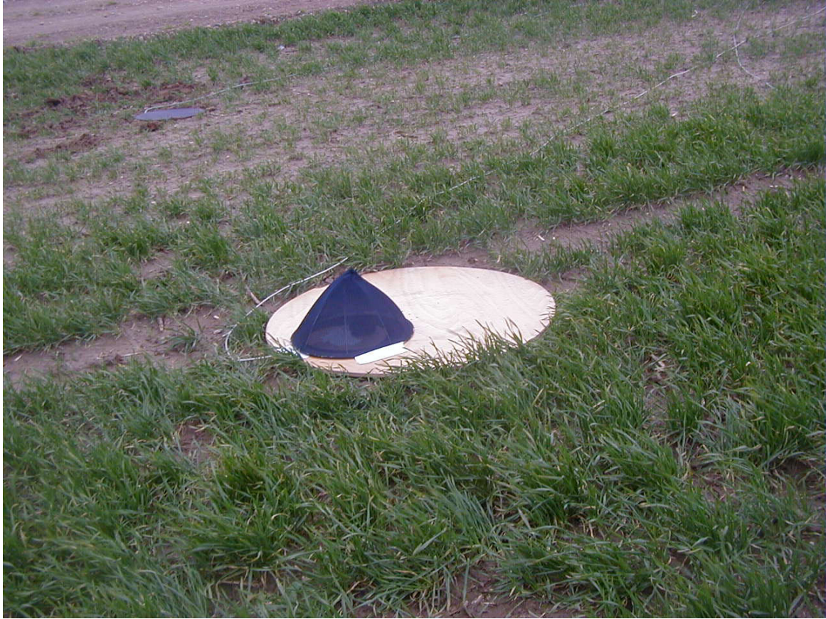
Abbildung 32: Mikrofon am MP1 auf einer schallharten Platte, Messung 07.01.2005
