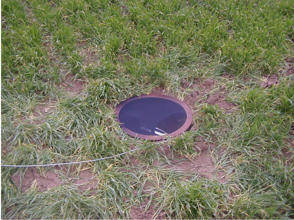
Abbildung 33: Mikrofon MP3 erdbündig auf einer Ringplatte (strömungsoptimiert), Messung am 07.01.2005
