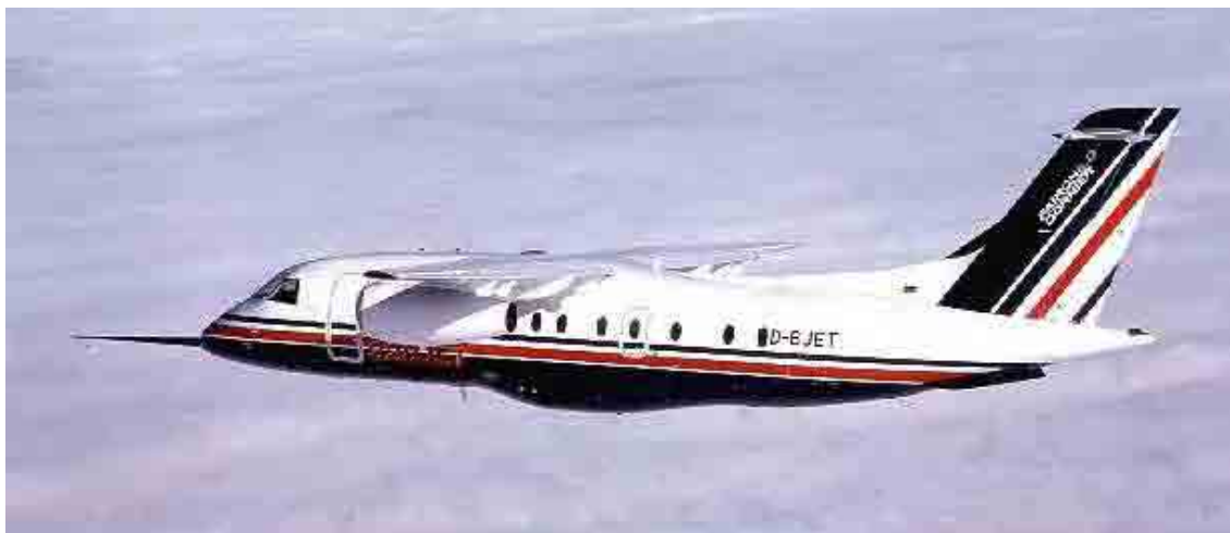
Bild 3.1 Beispiel für die Kennzeichenklasse B - Dornier DO 328 mit Strahltriebwerken (S 5.1)
