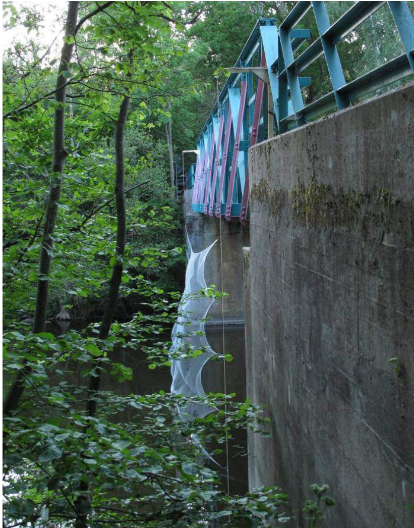
Abb. 6: Fangkonstruktion an der Kambser Brücke (FFH-Gebiet "Warnowtal mit kleinen Zuflüssen"). Das Fangnetz wird über zwei beschwerte Führungsleinen geführt, die bei einer relativ hohen "Stabilität" ein schnelles Einholen des Netzes ermöglichen.
