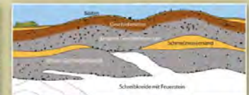
Schematisches geologisches Profil der Lagerung von eiszeitlichen Ablagerungen und Schreibleie auf Rügen
