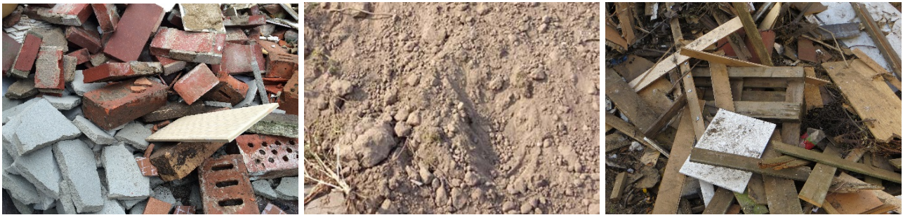
Ziegel- und Betonbruch, Boden, Altholz
