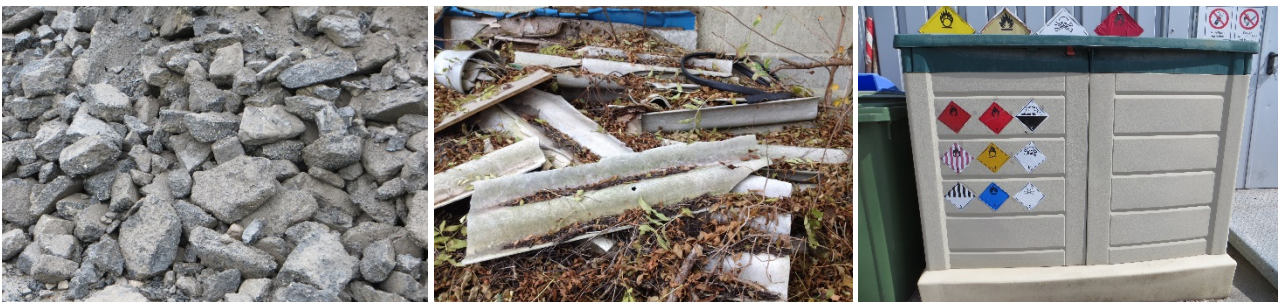
Straßenaufbruch (teerhaltig), Asbest, Schadstoffcontainer
