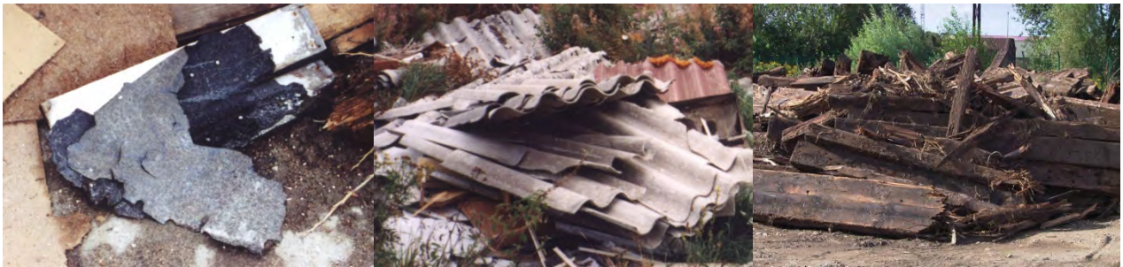
Teerpappe, Asbest, Bahnschwellen
