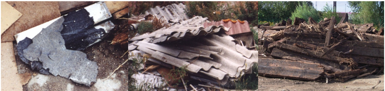
Teerpappe, Asbest, Bahnschwellen
