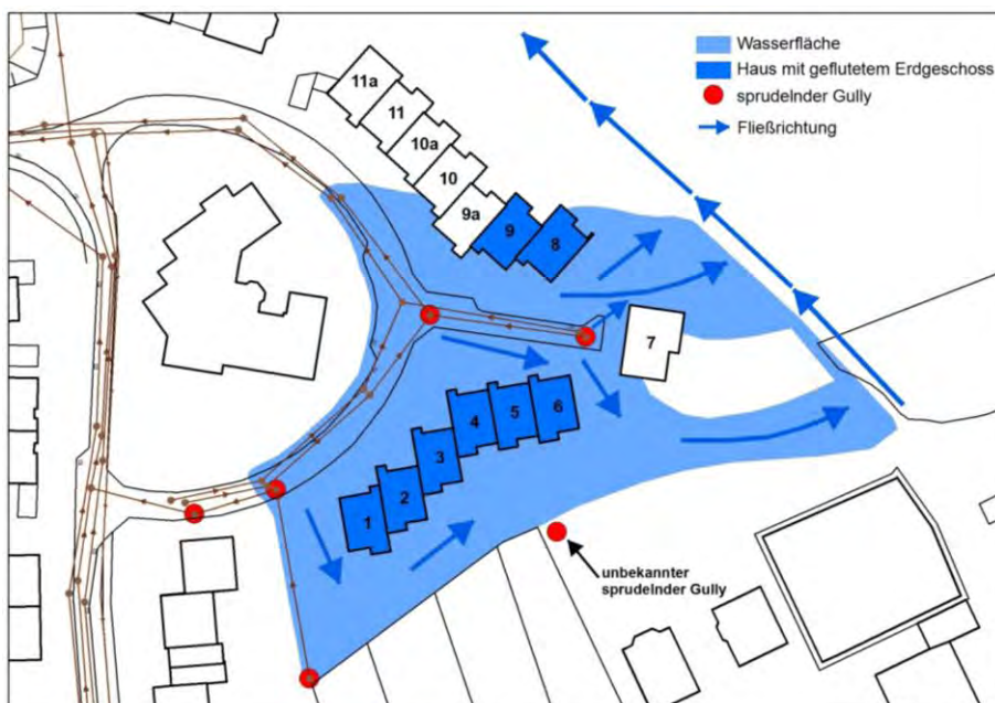
Abbildung 4-3: Überschwemmungsgebiet und Fließrichtung im Zeitraum 29.07-31.07.2011 in Evershagen Dorf (Rostock), Brigitte-Reimann-Ring, rekonstruiert nach einer Zeichnung des Anwohners Dr. Krüger, aus BIOTA (2012)
