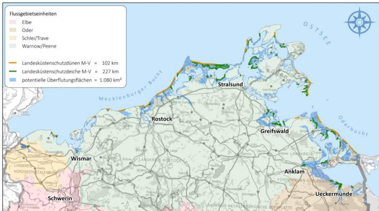
Abbildung 3: Küstenschutzanlagen in der FGE Warnow/Peene (Quelle: StALU Mittleres Mecklenburg)
