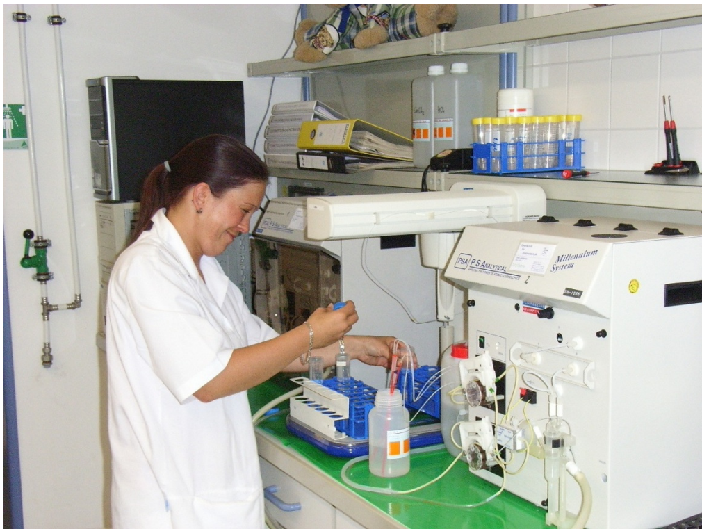
Abb. 2.3-2: Quecksilberbestimmung mittels Atomfluoreszenzspektrometrie im LUNG-Labor (Foto: A. Bachor)
