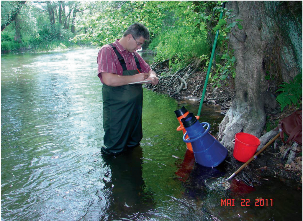
Abb. 2: Die Verwendung des Muschelguckkastens und des Drahtsiebkeschers sind generell zu empfehlen. Zusätzlich sollte jedoch auch immer das Freiwedeln und Fühlen mit der Hand ergänzend verwendet werden.
